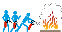
Acionar vários extintores em conjunto, não um de cada vez
